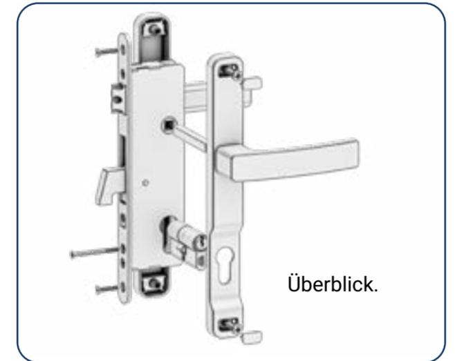
Schieben Sie den Schlosskasten in den Torflügel und ziehen Sie ihn mit dem Inbuschlüssel fest. Schieben Sie nun den Türgriff mit der Abdeckplatte zusammen mit dem Zylinderschloss in das Gehäuse und schrauben Sie die Abdeckplatte mit dem Schraubendreher fest.
