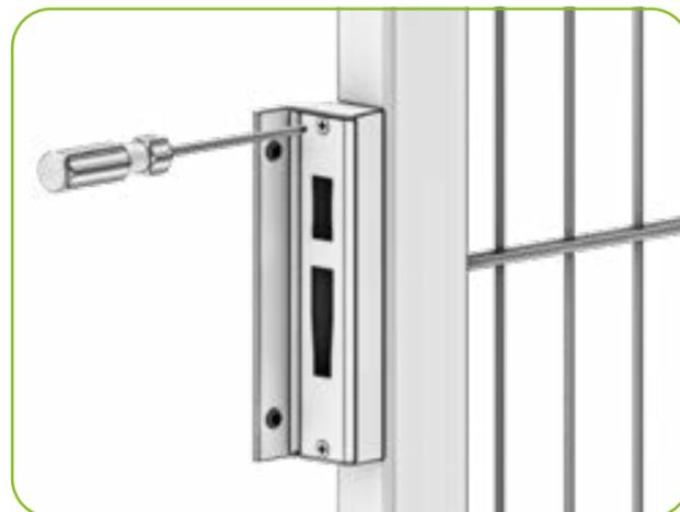
Befestigen Sie den Schlossfänger mit dem Inbusschlüssel und dem Schraubendreher. Achten Sie darauf, dass Sie den Schlossfänger in der richtigen Richtung in Bezug auf die Drehrichtung des Tores montieren.
