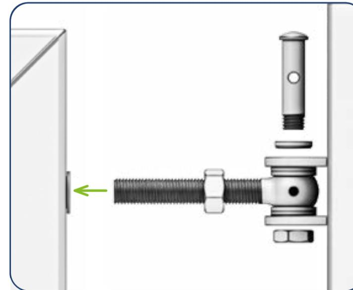
Stellen Sie die Scharniere im Voraus ein, um die Montage zu erleichtern. Ziehen Sie die Mutter an der Ringschraube an und ziehen Sie dann die Ringschraube im Torflügel fest. Ziehen Sie die Mutter noch nicht gegen den Torflügel an. Ziehen Sie die Ringschraube an beiden Scharnieren mit der gleichen Anzahl von Umdrehungen an.
