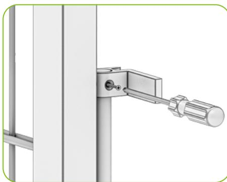
Schieben Sie den kleinen Hebel auf den Bolzen und sichern Sie ihn mit der mitgelieferten Schraube. Stecken Sie den großen Bolzen in die Halterung und stecken Sie den kleinen Bolzen in eines der gewünschten Löcher.
