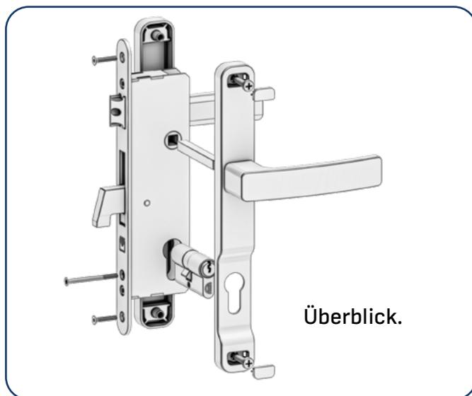
Schieben Sie den Schlosskasten in den Torflügel und ziehen Sie ihn mit dem Inbusschlüssel fest.
