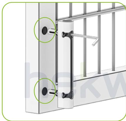
Platzieren Sie den Halter an der Stelle, an der Sie die Löcher gebohrt haben, und setzen Sie die Spreizmuttern in die Löcher ein. Ziehen Sie die Muttern mit einem Inbusschlüssel fest, so dass sich die Spreizmuttern ausdehnen.
