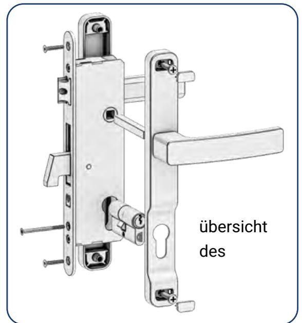
Schieben Sie den Schlosskasten in den Flügel und ziehen Sie ihn mit dem Inbusschlüssel fest. Schieben Sie nun die Klinke mit der Abdeckplatte zusammen mit dem Zylinderschloss in das Gehäuse und schrauben Sie die Abdeckplatte mit dem Schraubendreher fest.
