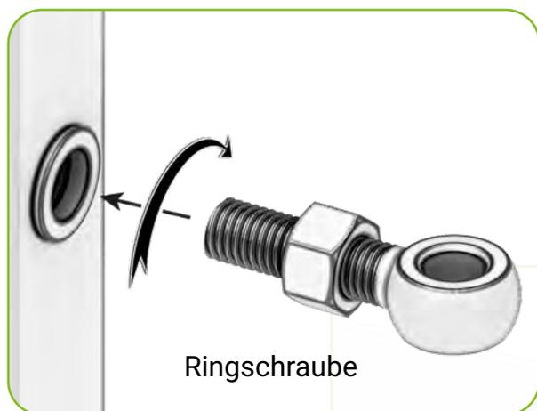
Stellen Sie die Scharniere im Voraus ein, um die spätere Montage zu erleichtern. Ziehen Sie die Mutter an der Ringschraube und anschließend die Ringschraube im Torflügel fest. Ziehen Sie die Mutter noch nicht gegen den Torflügel an. Ziehen Sie die Ringschraube an beiden Scharnieren mit der gleichen Anzahl von Umdrehungen fest.
