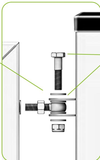
Vergewissern Sie sich, dass die Löcher der Scharnierplatten am Tor und der Ringschraube aufeinander ausgerichtet sind und führen Sie die Schraube hier durch. Vergessen Sie die Sicherungsringe nicht. Ziehen Sie die Schraube und die Mutter mit 2 Steckschlüsseln / Ringschlüsseln fest. Führen Sie dies für beide Scharniere durch.
