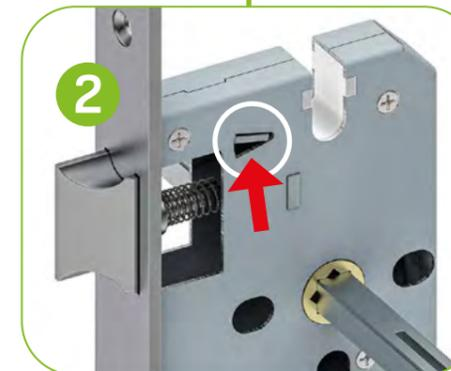
Drücken Sie die Sperrklinke nach oben, so dass Sie den Riegel eindrücken und umkehren können. Durch Loslassen schießt der Fallenriegel wieder nach vorne und setzt sich in die neue umgekehrte Position.
