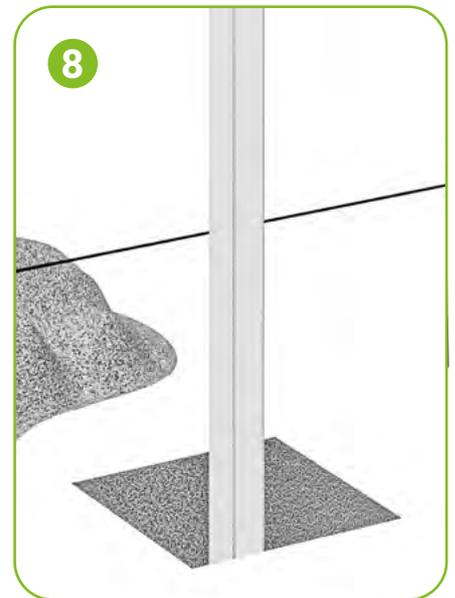
Sichern Sie den Pfosten ggf. mit **(Schnell-)Beton**. Bei Zäunen, die höher als 1 m sind, empfehlen wir, die Pfosten immer mit (Schnell-)Beton zu sichern. Befolgen Sie die Anweisungen auf der Verpackung. Nach der Installation des ersten Pfostens wiederholen Sie den Vorgang für alle Pfosten. Lassen Sie den Beton **aushärten**, bevor Sie die Zäune montieren.
