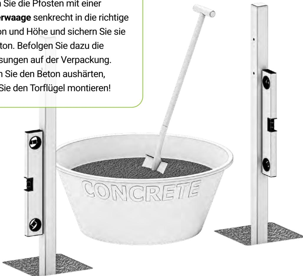
In diesem Schritt wird auch festgelegt, wie das Tor geöffnet und geschlossen wird. Achten Sie auf die richtige Positionierung der Pfosten.
