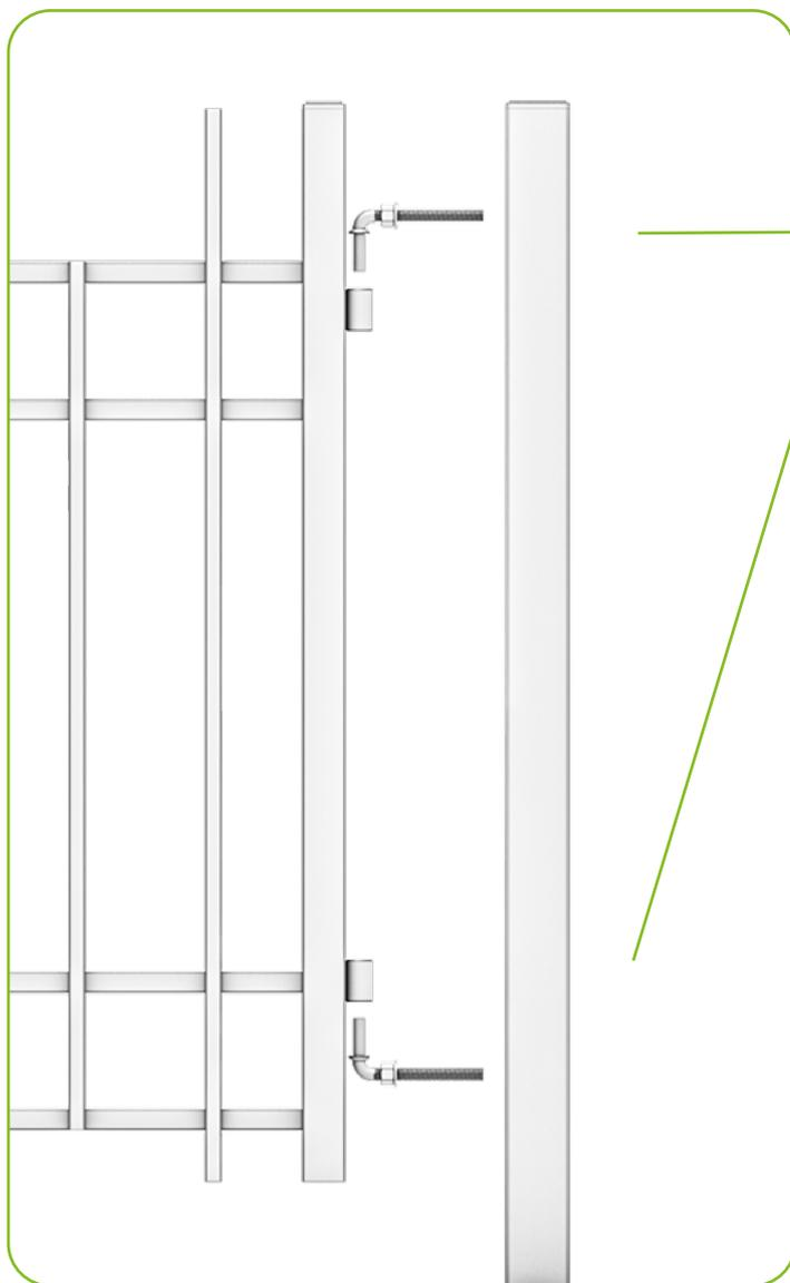
Stellen Sie die Scharnierstifte im Voraus ein, um die spätere Montage zu erleichtern. Ziehen Sie die Muttern an beiden Scharnierstiften gleichmäßig an, damit das Tor später gerade hängt. Montieren Sie die Scharnierstifte spiegelbildlich zueinander. Auf diese Weise kann die Tür nicht vertikal verrutschen.
