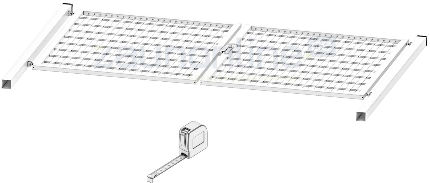
Bestimmen Sie die Drehrichtung und die Position des Tores, bevor Sie die Pfosten montieren.
