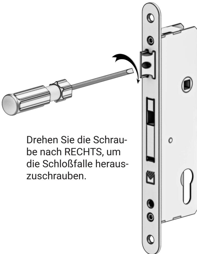
Drehen Sie die Schraube nach RECHTS, um die Schloßfalle herauszuschrauben.
