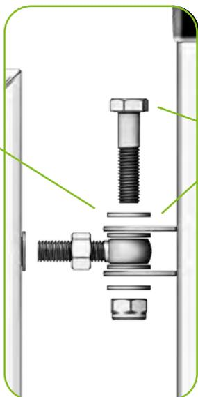
Richten Sie die Löcher der Ringschraube und der Scharnierplatte aus und stecken Sie die Scharnierschraube hindurch. Vergessen Sie die Sicherungsscheiben nicht. Stecken Sie einen Schraubendreher in die Ringschrauben und ziehen Sie die Mutter am unteren Ende der Schraube fest. Dies gilt für alle Scharniere.
