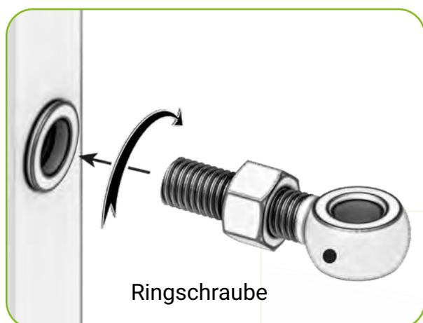
Stellen Sie die Scharniere im Voraus ein, um die Montage zu erleichtern. Ziehen Sie die Mutter an der Ringschraube an und ziehen Sie dann die Ringschraube im Torflügel fest. Ziehen Sie die Mutter noch nicht gegen den Torflügel an. Ziehen Sie die Ringschraube an beiden Scharnieren mit der gleichen Anzahl von Umdrehungen an.
