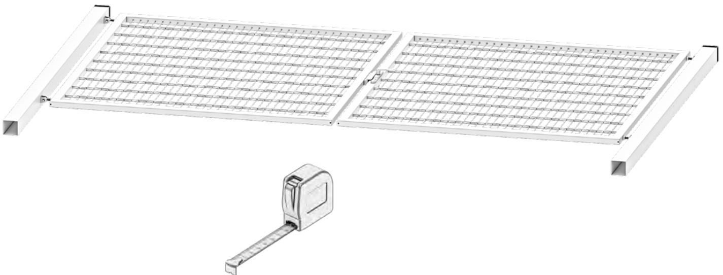
Legen Sie die Torteile auf eine weiche **Unterlage** und bestimmen Sie die Abmessungen.
