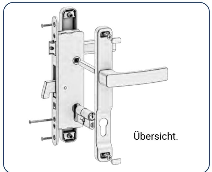
Schieben Sie den Schlosskasten in den Torflügel und ziehen Sie ihn mit dem Inbusschlüssel fest. Schieben Sie nun den Türgriff mit der Abdeckplatte zusammen mit dem Zylinderschloss in das Gehäuse und schrauben Sie die Abdeckplatte mit dem Schraubendreher fest.
